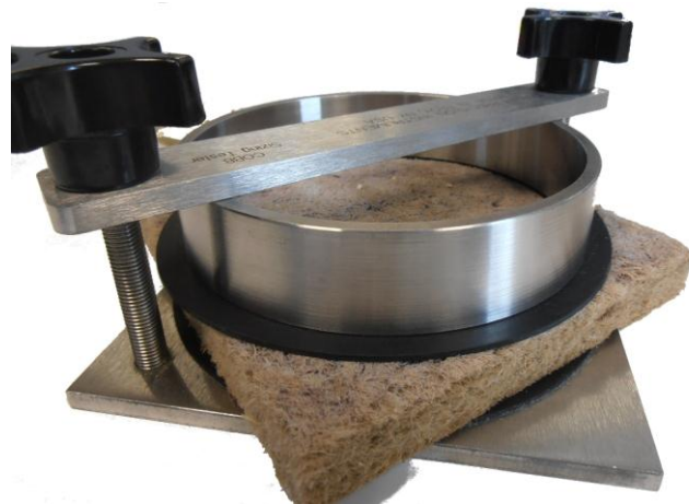
Figure 4 : Dispositif expérimental pour le test COBB.
